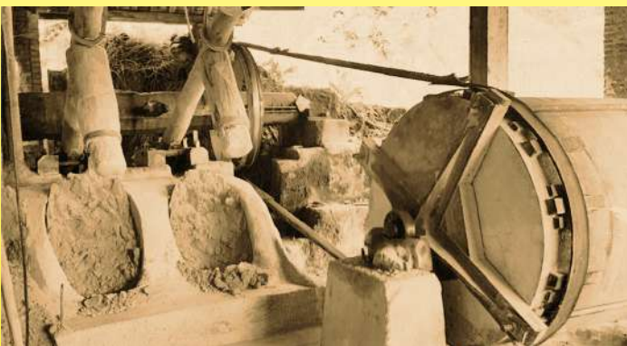
Máquinas tradicionales ((水碓 shui dui) para la producción de los polvos utilizados en la fabricación de la porcelana eléctrica (colección privada)
