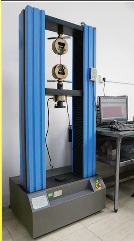
Banco de pruebas para ensayos de tracción
