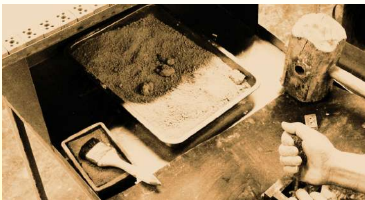
Bloques de terminales hechos a mano prensados con martillo: Llenado manual de granulado húmedo (colección privada) Secado de la porcelana eléctrica después de ser prensada (colección privada)
