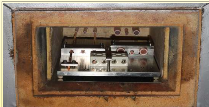
Horno de prueba para determinar la resistividad de la cerámica en función de la temperatura (laboratorio Ultimheat)
